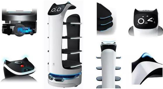
Die Bella ist flexibel einsetzbar, da sie sowohl Laser SLAM als auch visuelle SLAM Positionierungs- und Navigationslösungen unterstützt.
